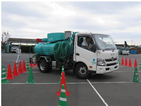
※ バックセンサーを使用して、狭いスペースでの方向転換訓練を実施(タコツボ訓練)
